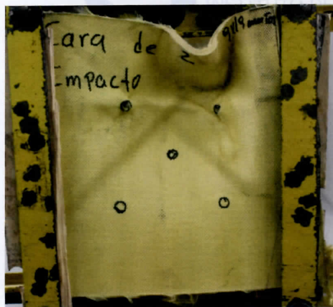
Disparo N°2. Zona de impacto superior derecho, sin observaciones.
